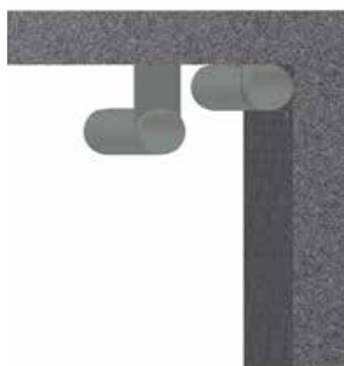
Montering av ventiler (don) kan ske med fästram eller direkt i röret.
