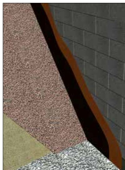
Bild 4.6 Källarvägg med LECA lättklinker
