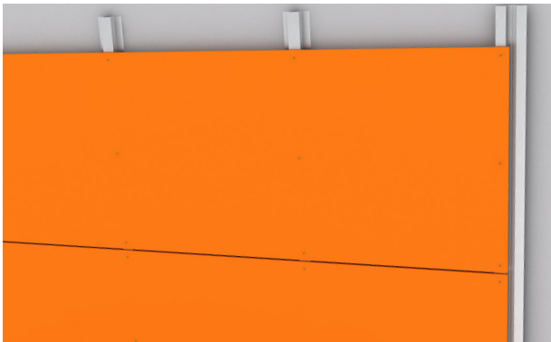
Liggande montering EPDM kan utelämnas på metalläkt.
